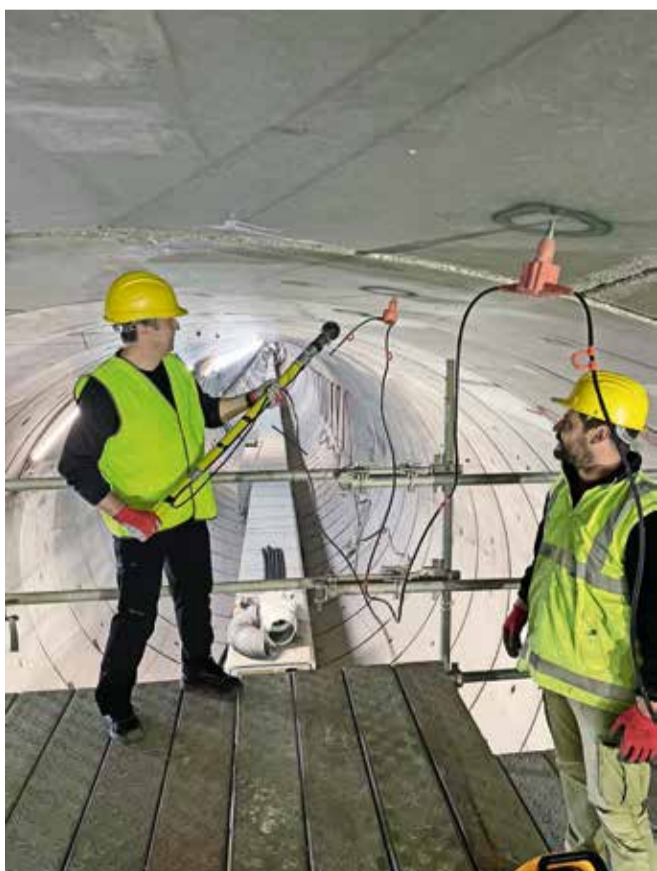
Generiranje umjetnog udarca na betonskoj oblozi
